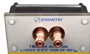
Etalonski otpornik otpornosti  $1 M\Omega$ , SM262.
