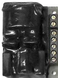
„Elektronski transformator“ za napajanje niskonaponskih halogenih sijalica, Simetri tip SN1.
